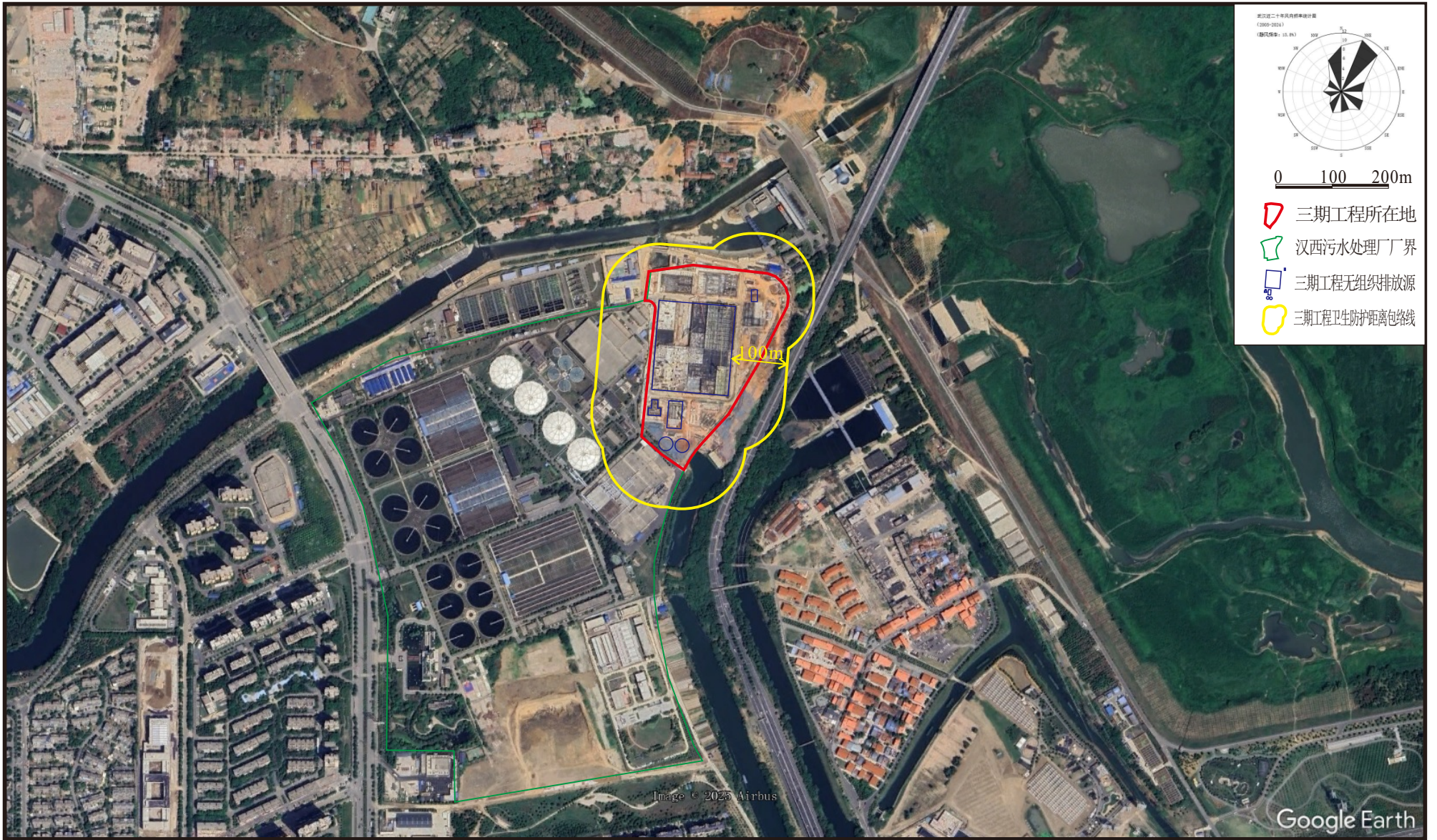
附图5 汉西污水处理厂三期工程卫生防护距离包络线示意图
