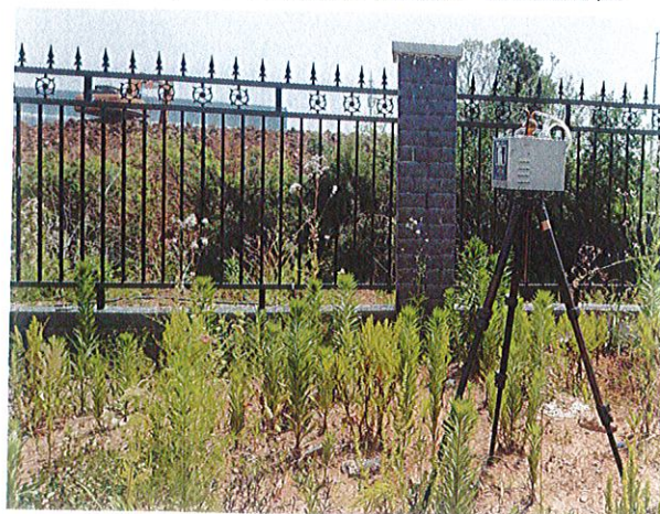
厂界上风向 O2#无组织排放废气检测点位
