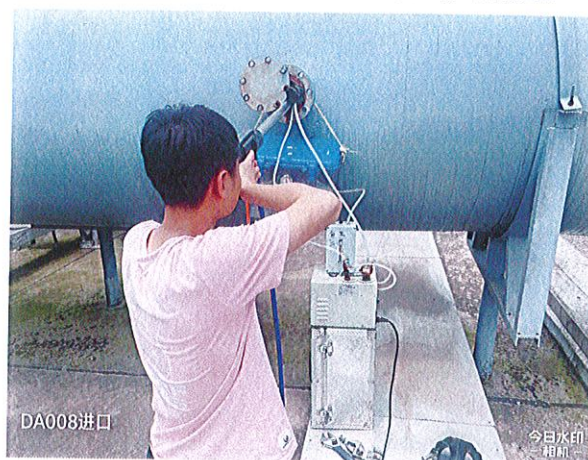
DA008 进口◎8#有组织排放废气检测点位
