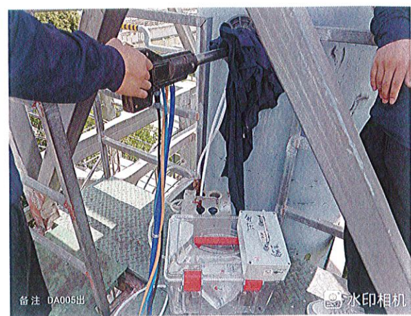
DA005 出口◎14#有组织排放废气检测点位
