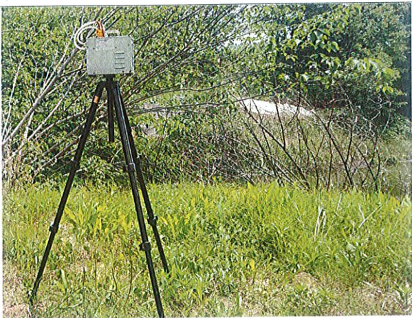
厂界上风向 O3#无组织排放废气检测点位
