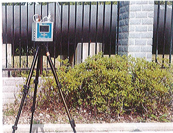
厂界下风向 O6#无组织排放废气检测点位
