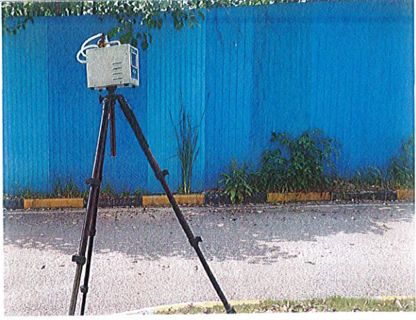
厂界下风向 O4#无组织排放废气检测点位
