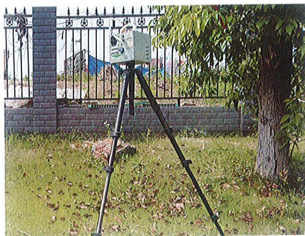
厂界下风向 O7#无组织排放废气检测点位
