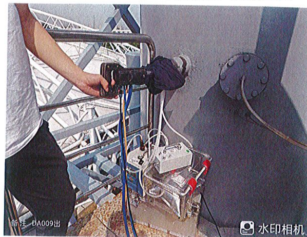
DA009 出口◎18#有组织排放废气检测点位
